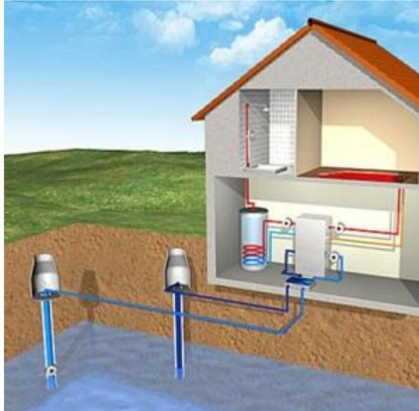
**Figura 4. 8: Pompa di calore ad acqua di falda**
