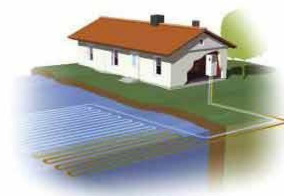
Figura 4. 11: Pompa di calore su acqua di superficie
