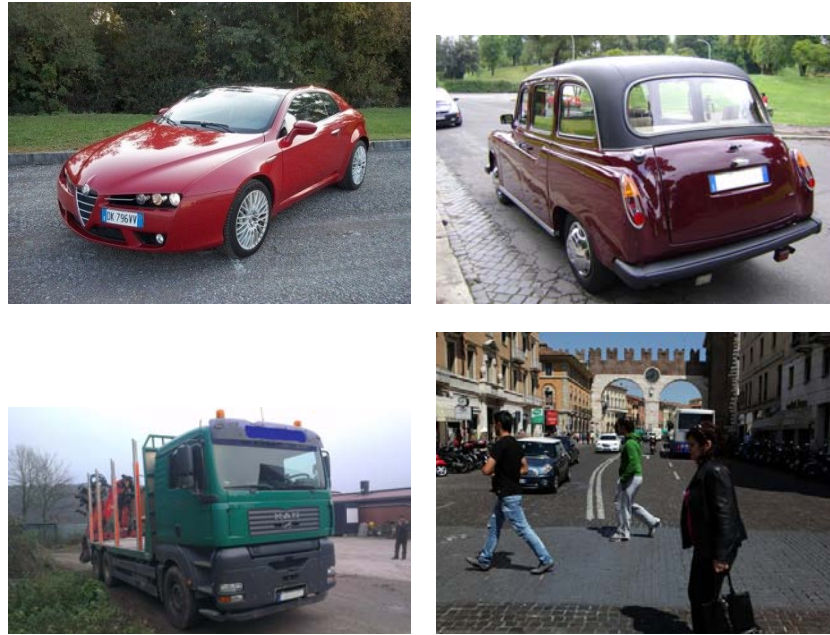
Figura 9: L'individuazione di veicoli con sensori passivi è un'operazione complessa perché essi possono variare nella forma, dimensioni e colori. In più il loro "aspetto" dipende dalla loro posizione e se ci sono altri oggetti nelle vicinanze
