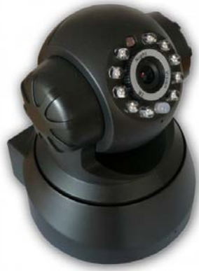
Figura 26: Un esempio di telecamera con comunicazione wifi, lente antiriflesso e visione notturna
