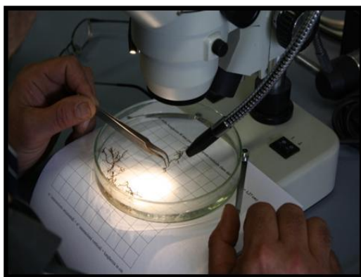
Operatore analizza radice fine allo stereoscopio
