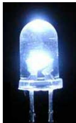
Figura 5.14: Luce emessa da un LED a radiazione blu con l'utilizzo di fosfori
