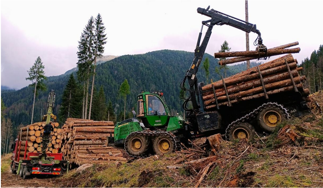
Figura 12: forwarder che ha lavorato nel cantiere di Paneveggio.
