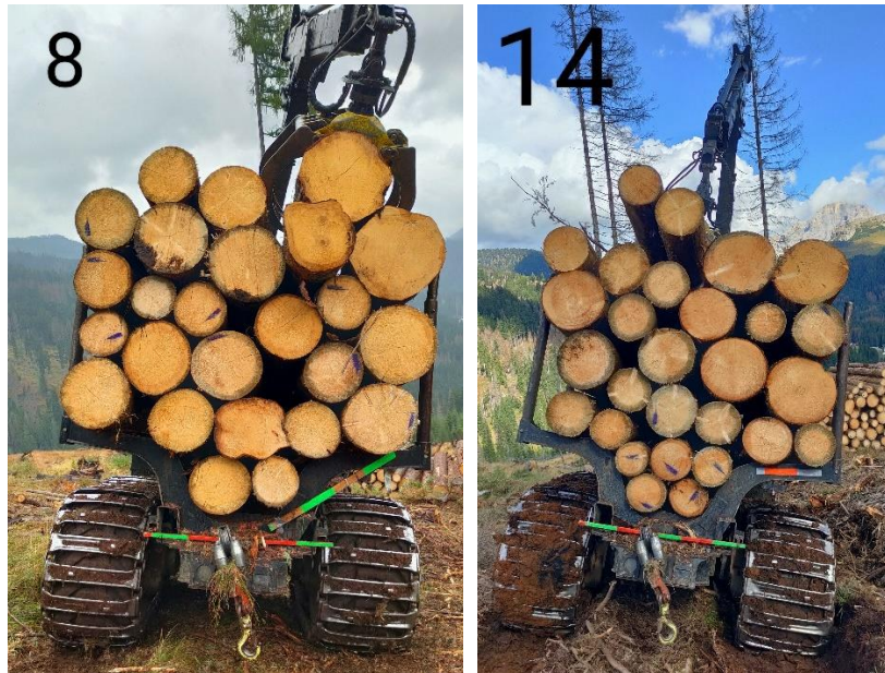
Figura 17: figure esemplificative del rilievo in campo per quanto riguarda le foto dei carichi, è possibile vedere il target di 25 cm utilizzato per la messa in scala.
