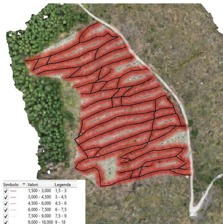
Figura 25: immagine che rappresenta la distanza delle aree di cantiere dalla pista più vicina e quindi rappresenta la distribuzione dell'area non trafficata delineata in un gradiente di rosso sfumato dalle piste di esbosco evidenziate in nero.
