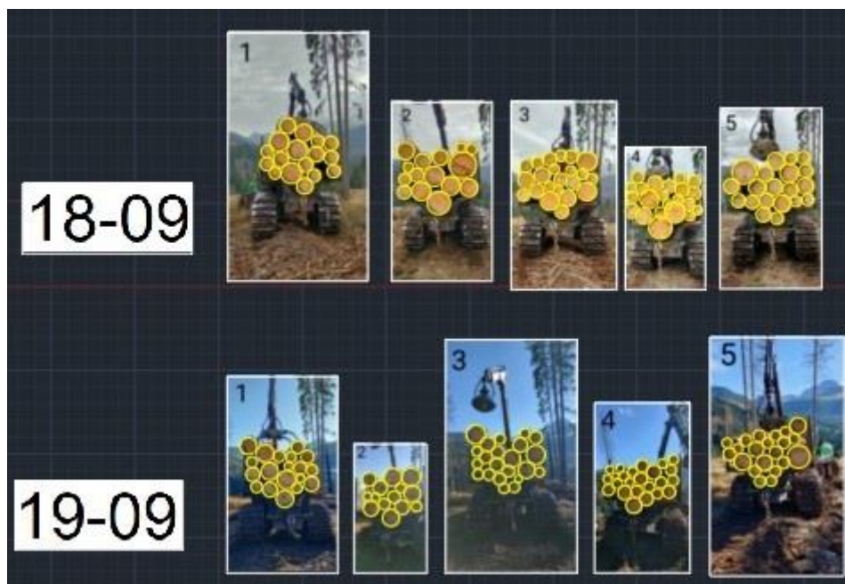
Figura 21: AutoCAD, estratto dall'elaborazione dei carichi con evidenziato ogni toppo.
