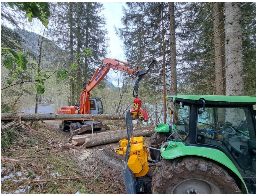
Foto 1.3.3 allestimento con processore e concentramento con trattore e verricello. Tarvisio (UD). Anno 2024 Pittino Valentino
