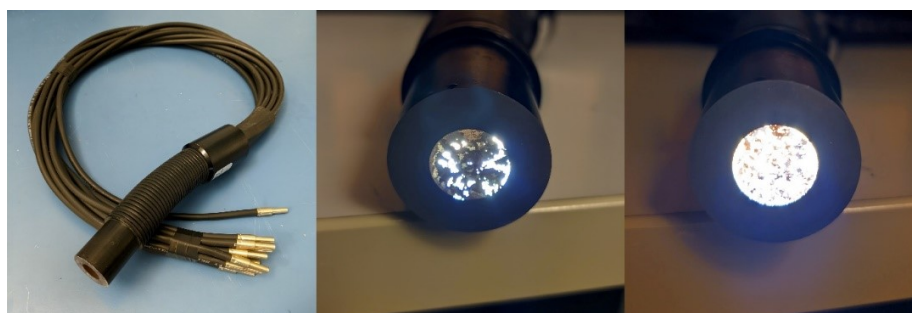
Figura 3.1.1 a) fibra di grosso diametro che si dirama in più fibre di piccolo diametro; b) uscita ponendo una sorgente luminosa davanti ad una sola fibra d'ingresso; c) uscita ponendo una sorgente luminosa davanti a tutte le fibre d'ingresso
