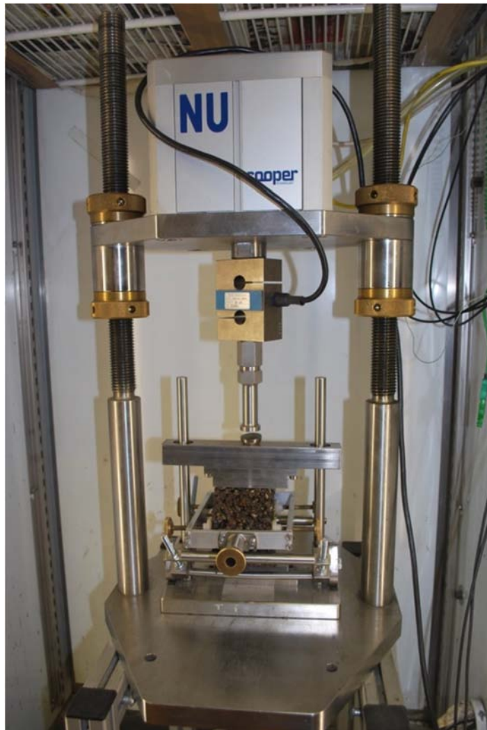
Figura 9.10 Cella di carico Cooper NU-14 del Laboratorio Sperimentale di Strade dell'Università di Padova per la misura del modulo di rigidezza secondo la norma europea UNI EN 12697 – Annesso C – Trazione indiretta
