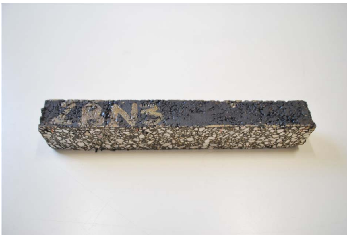
Figura 8.17 Provini prismatici composizione B
