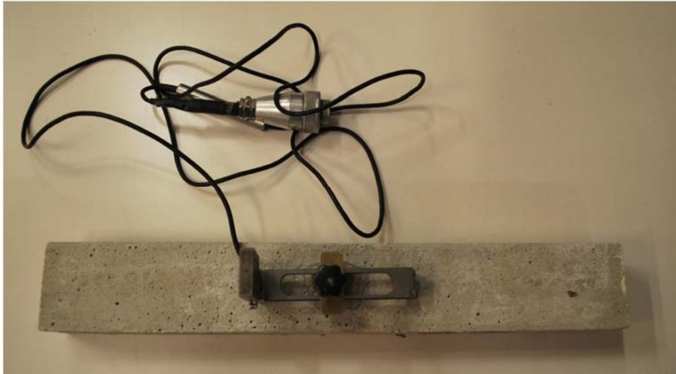
Figura 9.32 Trasduttore di spostamento installato su provino prismatico di calcestruzzo - vista dall'alto
