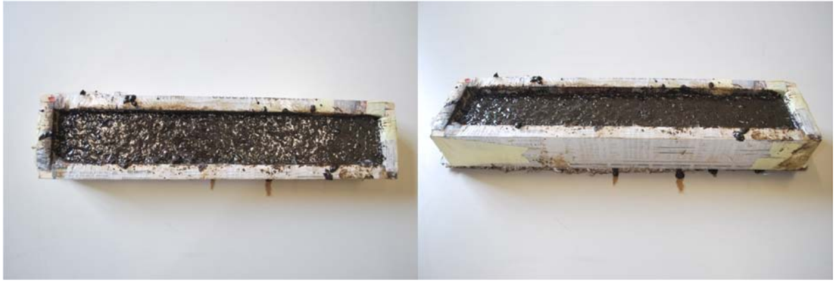
Figura 8.3 Cassero per il confezionamento di provini prismatici
