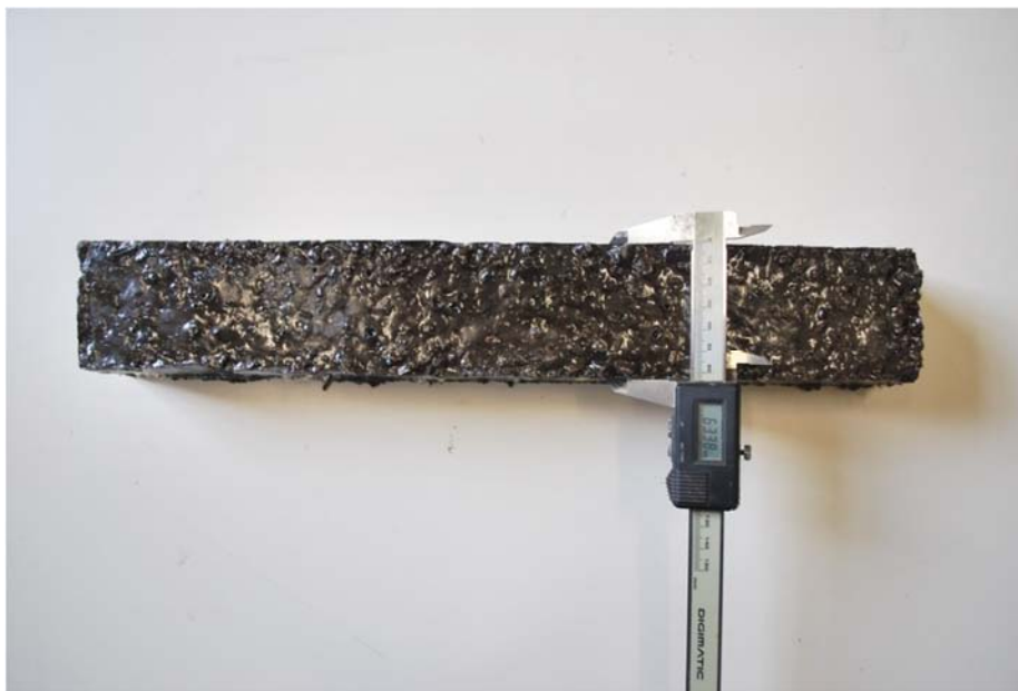
Figura 8.4 Misurazione di un provino prismatico con calibro Vernier
