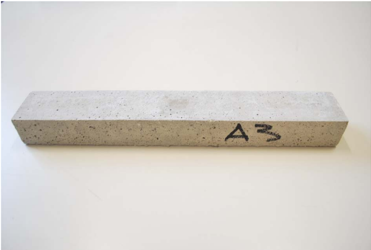
Figura 8.18 Provini prismatici composizione CLS
