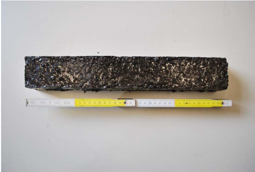
Figura 8.5 Misurazione di un provino prismatico con metro
