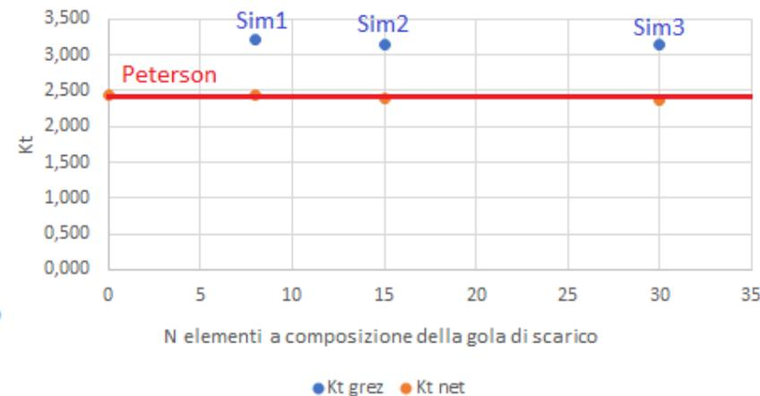
Kt spallamento per ruota dentata
