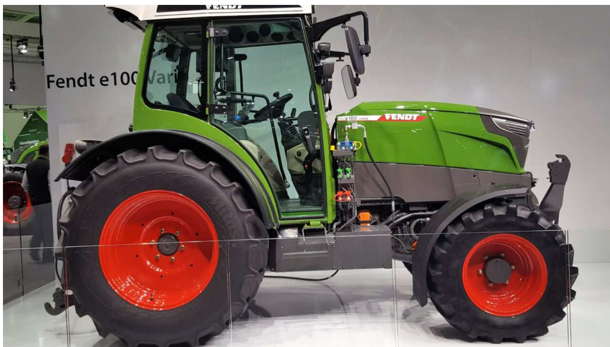
Figura 3.6 Il trattore elettrico Fendt e100 Vario
