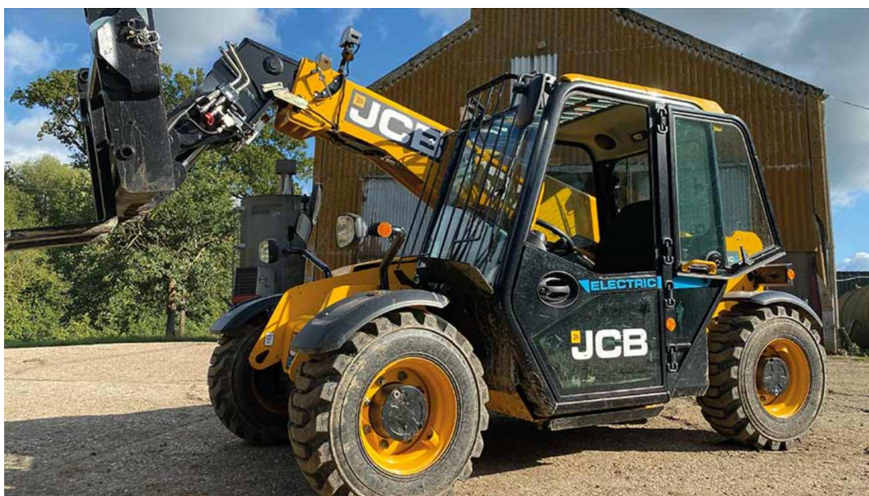
Figura 3.11 Il sollevatore telescopico elettrico JCB 525-60E testato dalla rivista Farmers Weekly.
