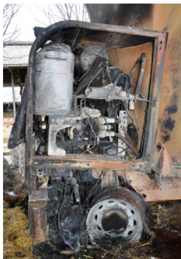
Fig. 5.6a: a sinistra viene riportato il motore del macchinario danneggiato dall'incendio.
