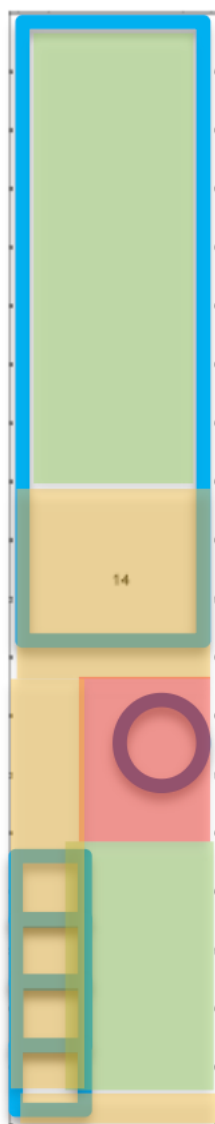
Fig. 5.5: La mappa cromatica dei danni riportati dal fabbricato in esame. Cerchiato in blu è riportato il carro miscelatore e indicate in celeste ci sono le vasche di contenimento del mangime, del fieno e delle farine.
