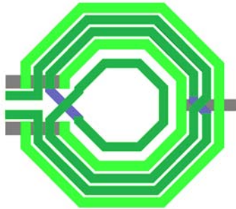
Figura 3.19: Vista dall'alto del trasformatore di uscita dimensionato per avere 17dBm sul carico.
