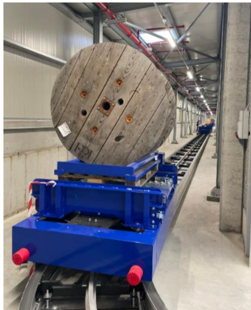
Figura 22- Shuttle con bobina caricata che va verso Stock
