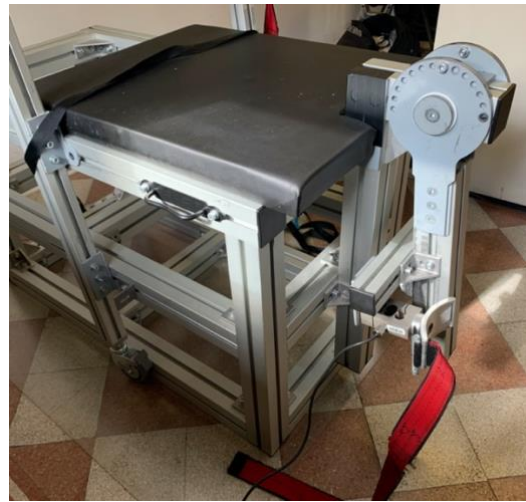
Figura 6. Dinamometro isometrico (custom-made) utilizzato durante il protocollo di valutazione neuromuscolare per misurare la forza volontaria isometrica (massima e sub-massimale) in estensione di ginocchio, concomitante alla registrazione del segnale HDsEMG.
