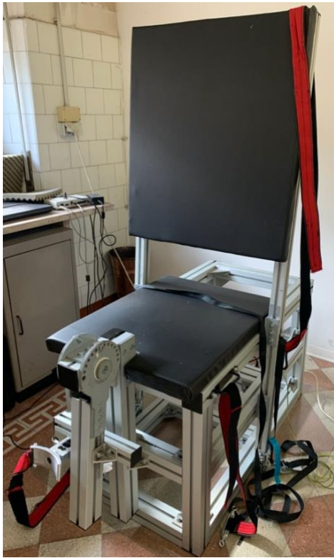
Figura 6. Dinamometro isometrico (custom-made) utilizzato durante il protocollo di valutazione neuromuscolare per misurare la forza volontaria isometrica (massima e sub-massimale) in estensione di ginocchio, concomitante alla registrazione del segnale HDsEMG.
