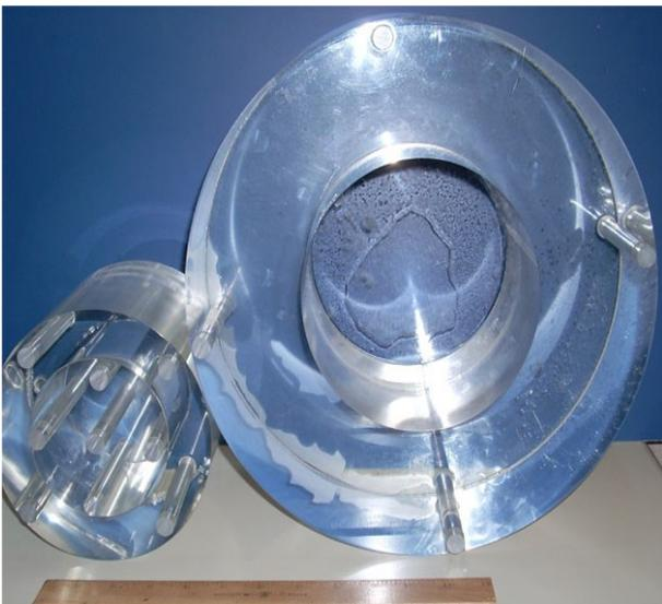
**Figura 13.** Fantoccio con camere a ionizzazione. L'immagine illustra due cilindri standard per il calcolo del CTDI. Il cilindro più piccolo sulla sinistra ha un diametro di 16 cm, invece quello sulla destra ha un diametro di 32 cm
