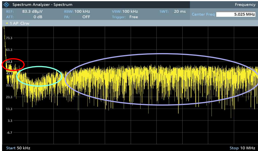
Spettro delle emissioni condotte, con V_{IN}=32V - V_{OUT}=1,5V e filtri in ferrite
