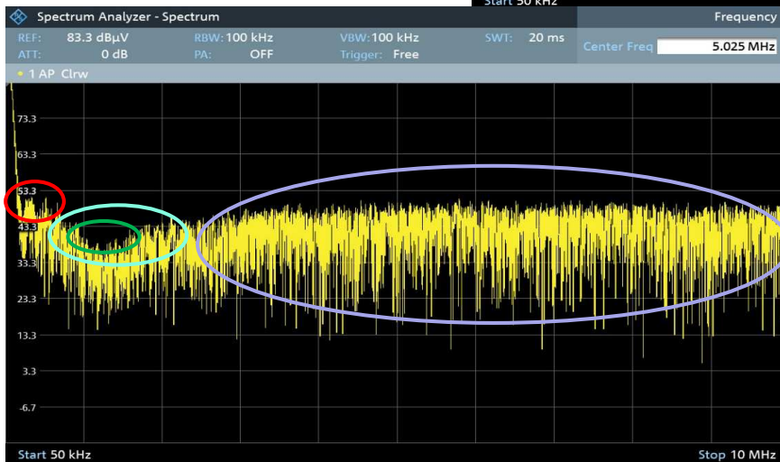
Spettro delle emissioni condotte, con V_{IN}=32V - V_{OUT}=1,5V e filtri in ferrite
