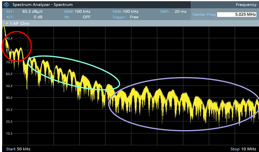
Spettro delle emissioni condotte, con V_{IN}=5V e filtri in ferrite
