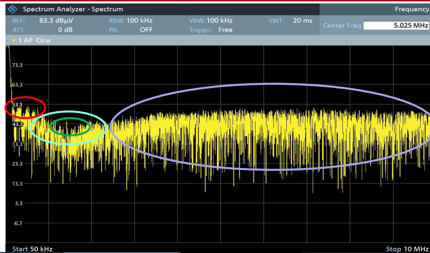
Spettro delle emissioni condotte, con V_{IN}=32V - V_{OUT}=1,5V , senza filtri
