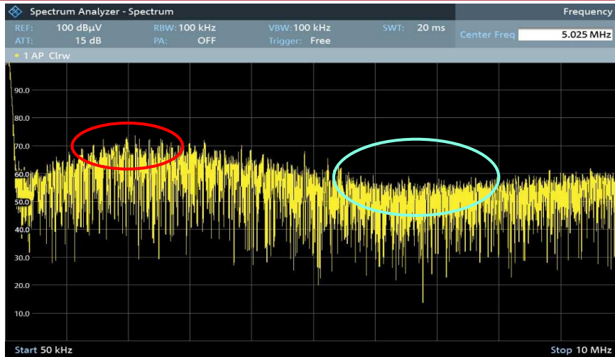
Spettro delle emissioni radiate, con V_{IN}=32V - V_{OUT}=1,5V e filtro EMI (CW1B-10A-L)
