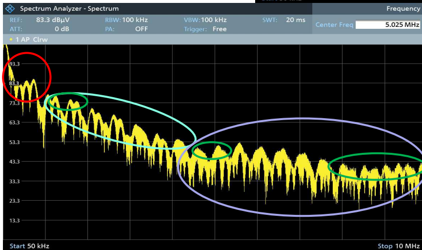
Spettro delle emissioni condotte, con V_{IN}=5V e filtri in ferrite
