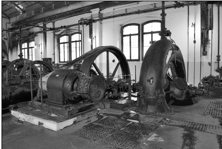
Fig. 2.19 – Esempio di antica idrovora, macchina utilizzata durante gli ultimi decenni delle bonifiche per prelevare acqua da un corso d'acqua ed immetterla in un altro (immagine tratta da www.flumina.com ).
