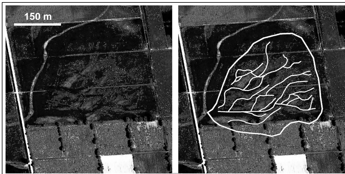
Fig. 5.7 – Esempio di fotointerpretazione della traccia di una rotta fluviale (rappresentata dal poligono contornato in bianco) e dei canali di rotta che si sviluppano al suo interno (le tracce lineari interne); nord verso l'alto.
