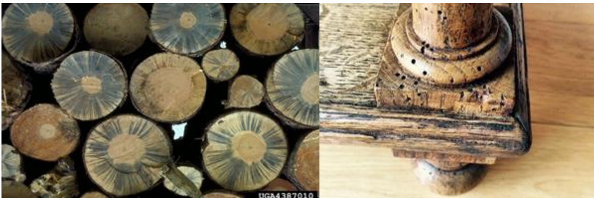
Figura 2: Esempi di danni causati da insetti xilofagi sul legno, sia vivo che in opera: a sinistra “azzurramenti” causati da un fungo simbiote; a destra fori di tarli su un mobile.
