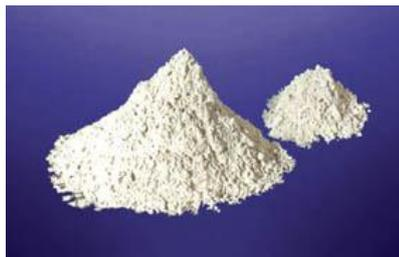
Figura 5.7 – Aspetto del nitruro di alluminio
