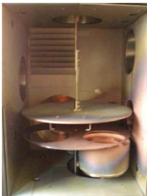
**Figura 6.3** – Interno della camera di sputtering
