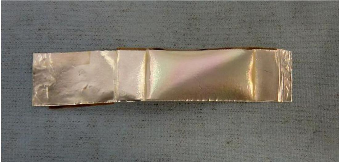
**Figura 6.8** – Foto del substrato con deposito dopo la rimozione delle sbarrette di supporto e del vetrino
