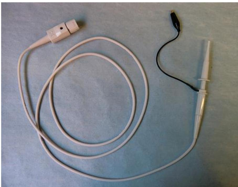
**Figura 7.4** – Sonda passiva di tensione YOKOGAWA di laboratorio
