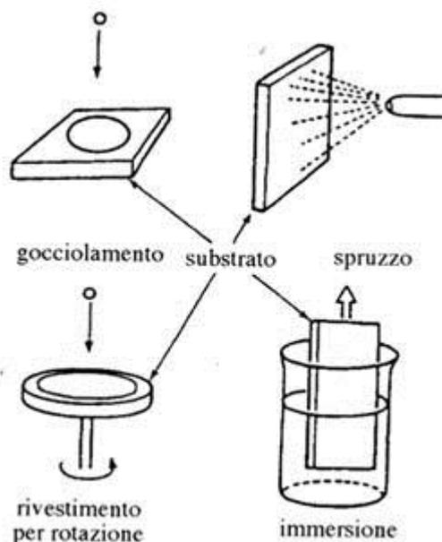
**Figura 1.10** – Tecniche di ricoprimento del substrato nel metodo sol-gel
