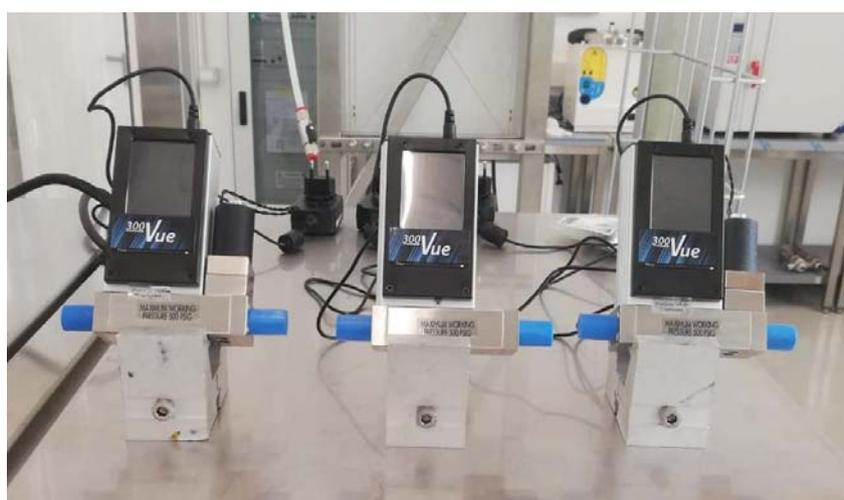
Figura 14: Esternamente i controllori di flusso di idrogeno ed anidride carbonica, dotati di elettrovalvola. Centralmente il flussimetro per il controllo del flusso di gas transitante dopo la miscelazione
