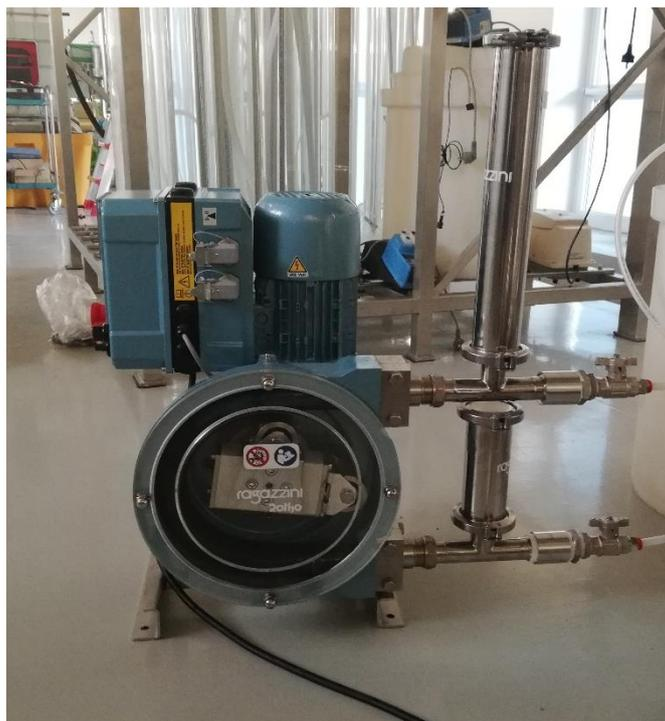
Figura 11: Pompa peristaltica
