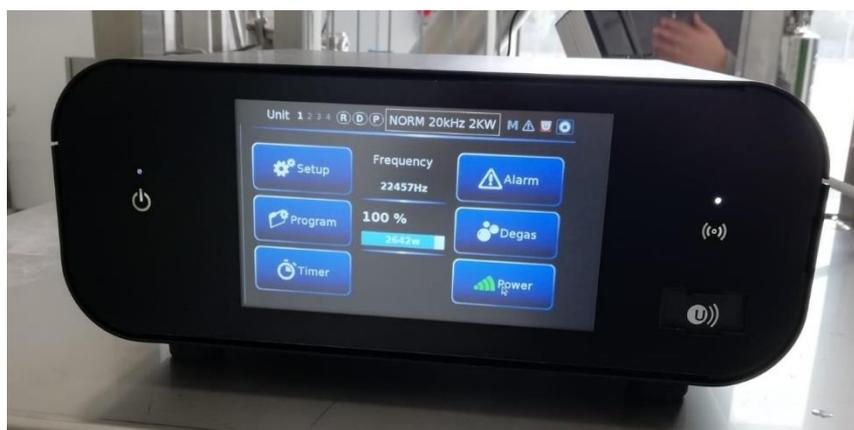
Figura 13: Generatore di ultrasuoni
