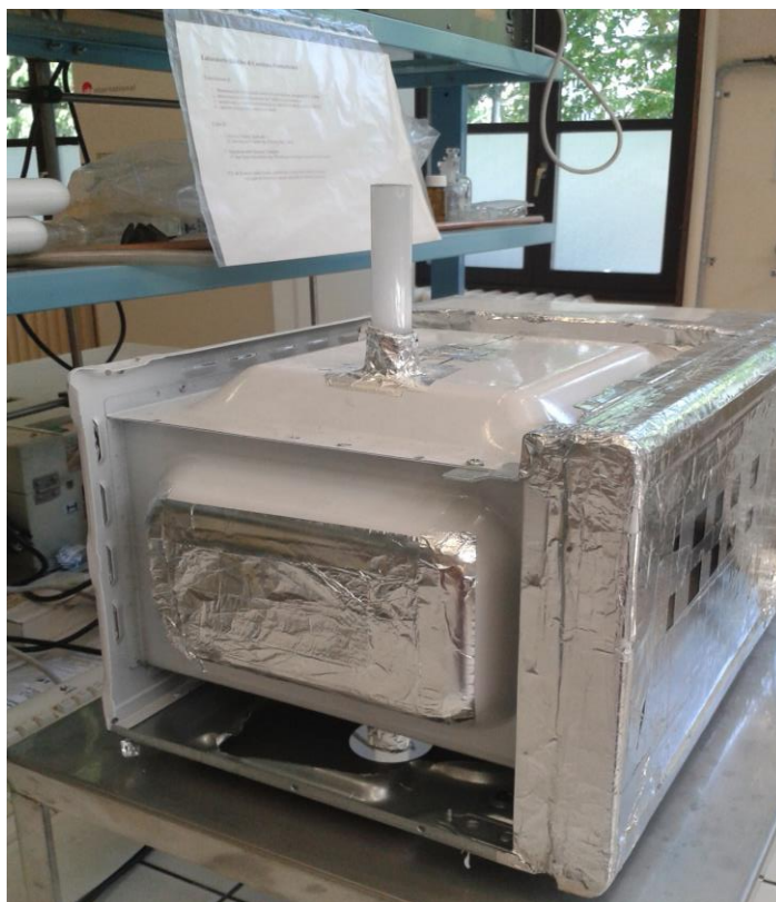
Figura 3.1. Forno commerciale schermato esternamente con fogli di alluminio e forato sulla parete superiore e inferiore per l'inserimento del tubo di quarzo.
