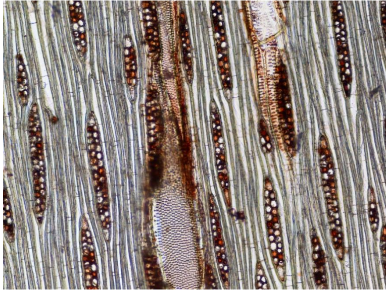
Figura 1-11 Punteggiatura alterna in una cellula vasale di Aucoumea klaineana Pierre (sez. tangenziale)
