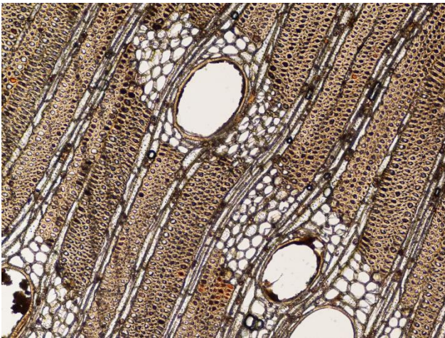
Figura 1-14 Parenchima assiale paratracheale vasicentrico, aliforme e confluyente in Afzelia spp. (sez. trasversale).
