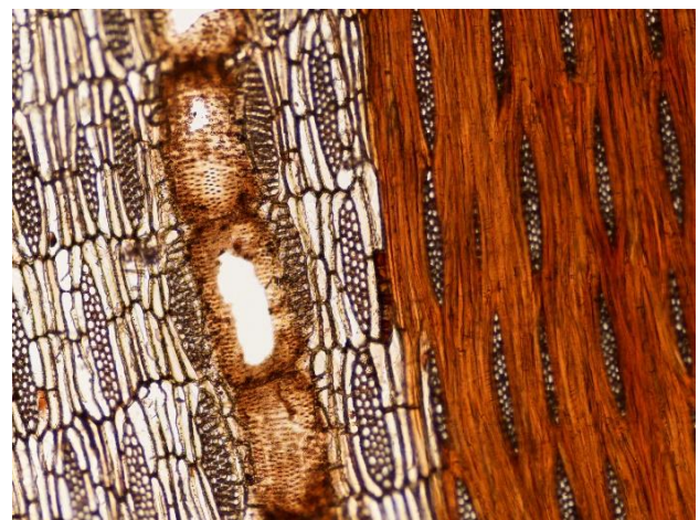
Figura 1-10 Elementi vasali sovrapposti in Millettia stuhlmannii Taub.(sez. tangenziale).
