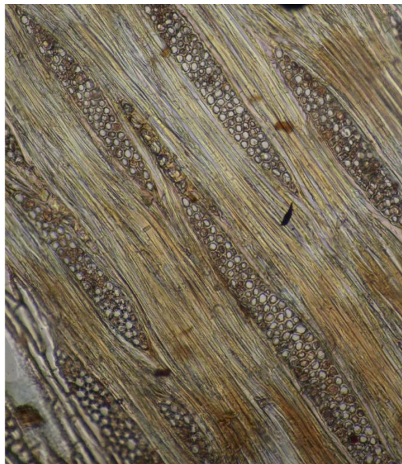
Figura 4-2 Raggi multiseriati in sezione tangenziale di Guibortia arnoldiana J. Leònard.
