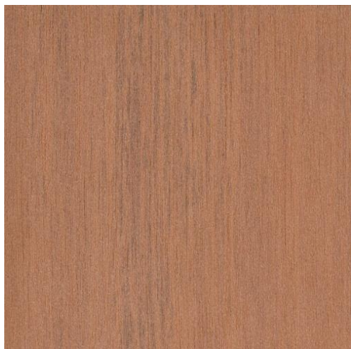
Figura 3-1 Foto di Abura ( Mitragyna ciliata Aubrèv. et Pellegr.), in sezione radiale, tratta da Wood database (2015), nella quale è appena percepibile la venatura.
