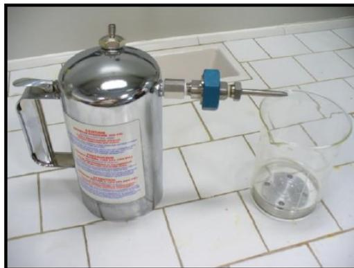
Figura 3.2\_ Strumento per il lavaggio con getto in pressione
