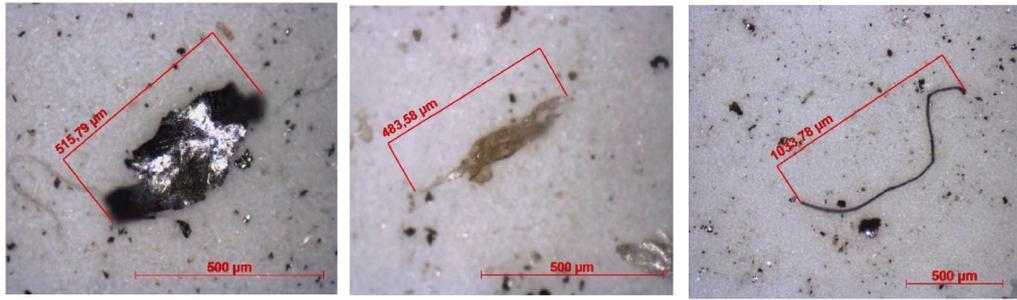
Figura 6.2\_(Da sinistra a destra) Particella riflettente, non riflettente e fibra
