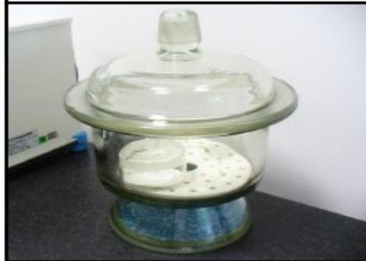
Figura 3.7\_Essiccatore: contenitore con silice colloidale essiccata utilizzato per lo stoccaggio dei filtri
