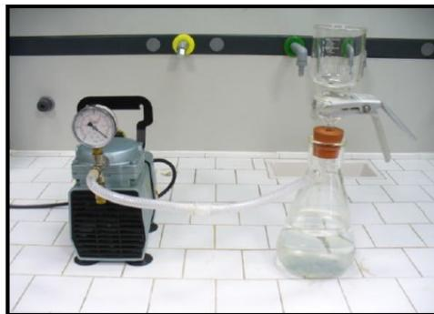
Figura 3.4\_Pompa a vuoto e membrana per filtraggio
