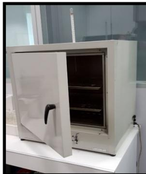
Figura 3.5\_ Forno per l'essiccazione membrana
