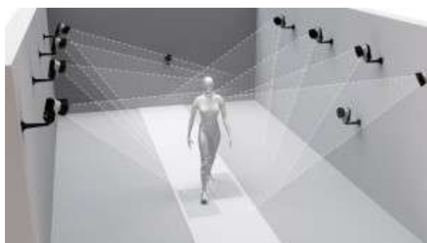
Figura 1.3: Esempio di setting del sistema optoelettronico, con le telecamere ad infrarossi e sul soggetto i marker catarifrangenti.
