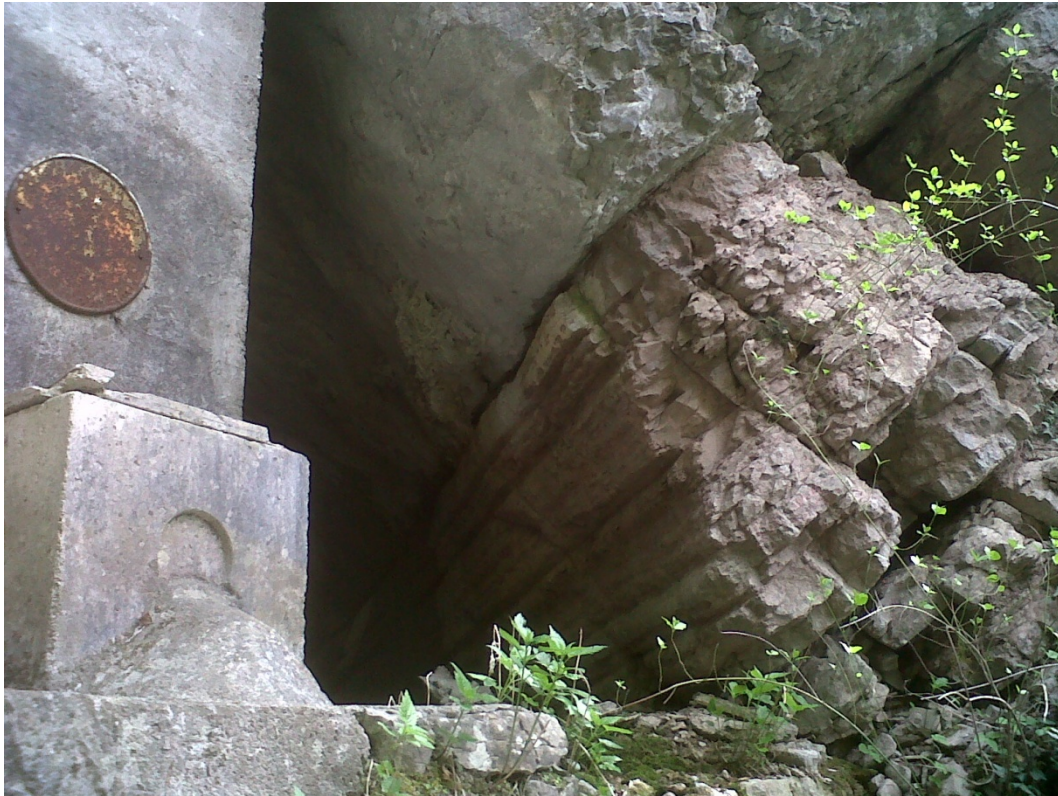
Fig. 55 Evidenza del contatto litologico tra Calcare del Vajont e Formazione di Igne.
