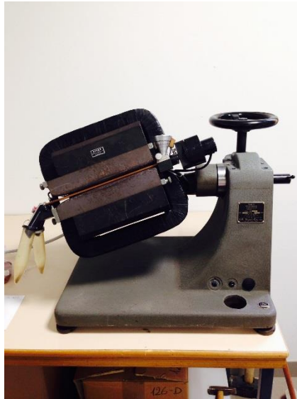
Figura 3.3. Separatore magnetico, Frantz.
