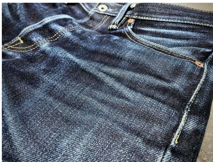
Figura 4: Dettaglio di baffatura
