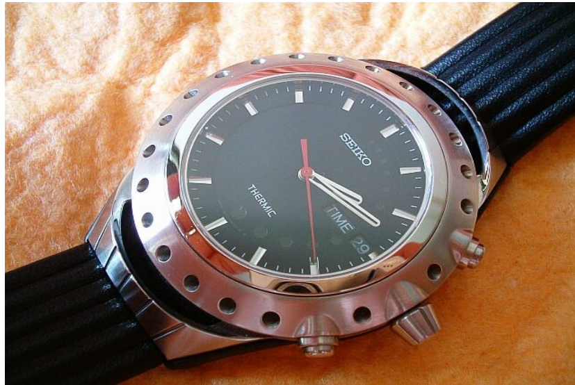
Figura 10: Seiko Thermic Watch, un'esempio di orologio alimentato tramite un convertitore di energia termica.
