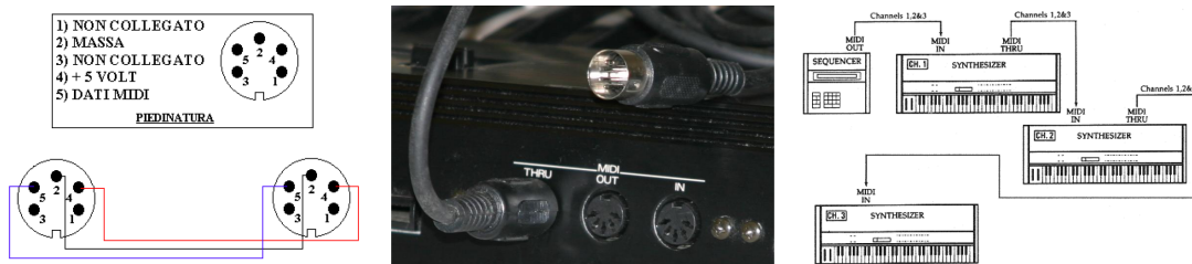
Figura 3.5: Schema Connettore DIN a 5 poli
