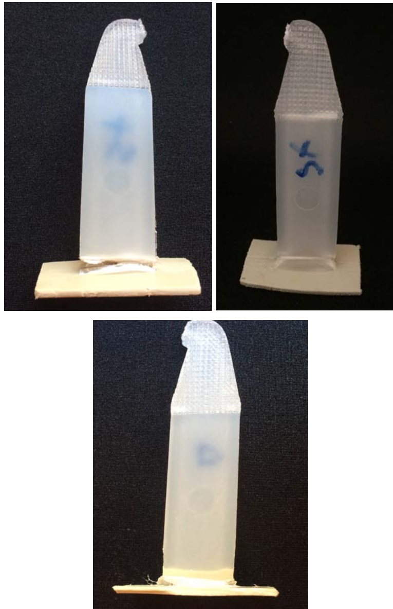
Fig. 4.13: Immagine interfaccia con deformazione senza rottura
