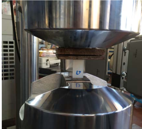
Fig. 3.16: Particolare del posizionamento del provino in controllo di carico
