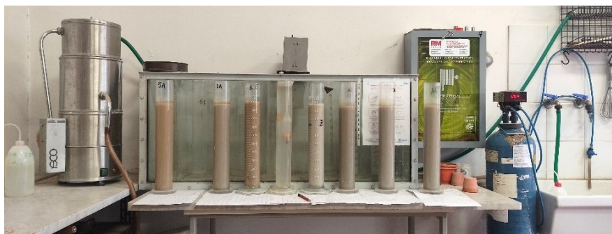
Figura 16 - Aerometrie in fase di svolgimento
