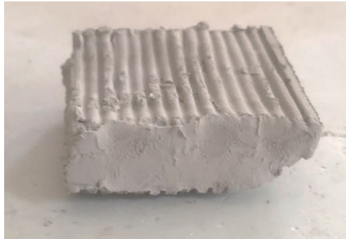
Figura 22 - Campione dopo una prova di taglio diretto. È visibile la superficie di taglio orizzontale.
