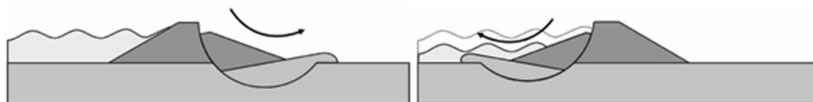
Figura 9 - Schema instabilità rotazionale profonda [CIRIA et al., 2013]
