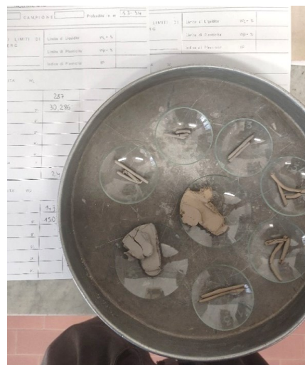
Figura 18 - Limiti liquidi e plastici eseguiti in laboratorio
