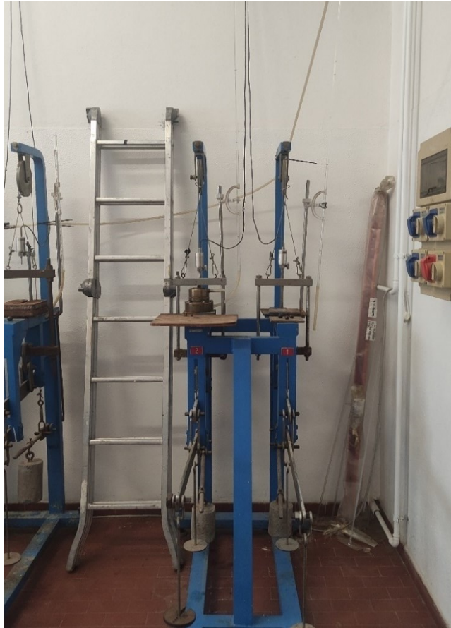
Figura 25 - Prova in cella edometrica in corso di svolgimento
