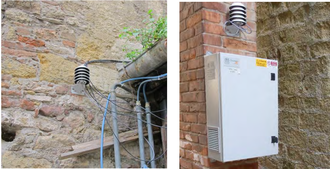
Fig. 9.5 e 9.6 – Sensori di Temperatura e umidità rispettivamente di Zona Chiesa e Museo
