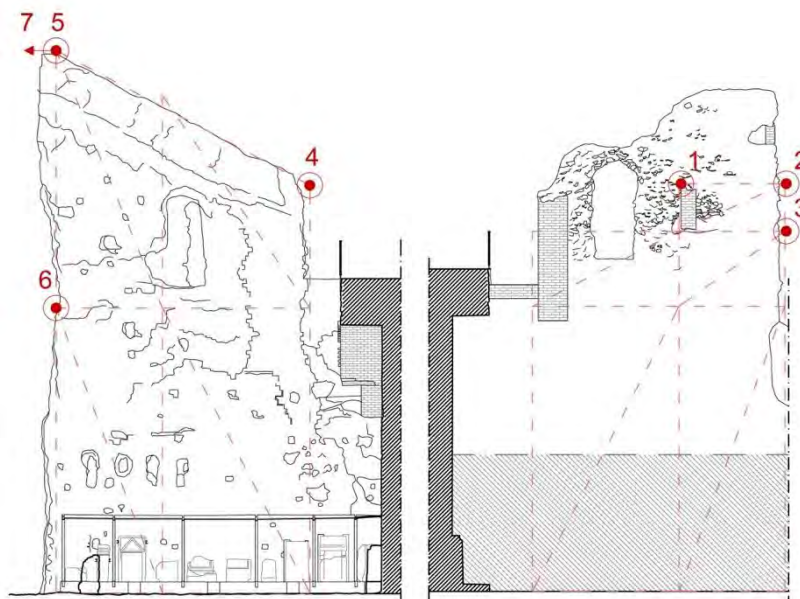
Fig. 8.2 – A3, A4 schema rappresentativo della posizione degli accelerometri e della configurazione usata per ArteMis
