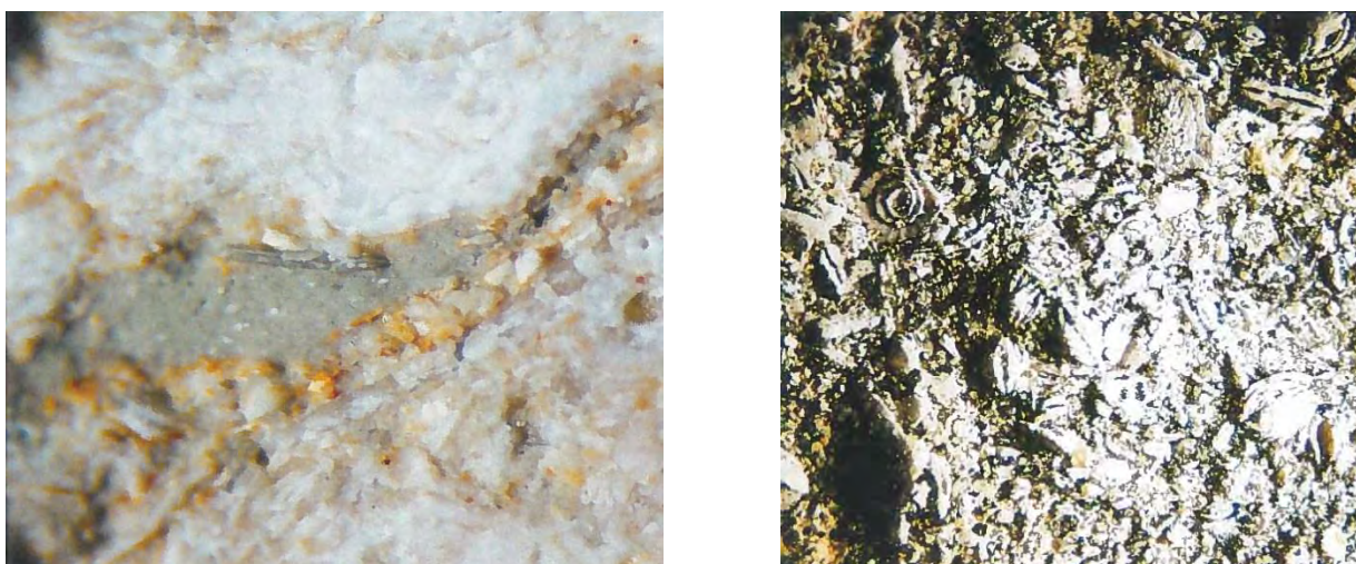
Fig. 4.45 e 4.46 – La prima foto illustra un guscio nella roccia del teatro: la roccia risulta molto eterogenea a causa di tali discontinuità e ha un comportamento anisotropo nei confronti delle dilatazioni termiche. La seconda foto mostra un ingrandimento della superficie di un muro della scena. Essa evidenzia come la superficie della roccia sia costellata di numerosi fossili, formariniferi in larga maggioranza. La roccia risulta molto porosa e adatta a fermare le particelle inquinanti presenti in atmosfera, che contribuiscono al suo annerimento, oltreché soggetta ad azioni termiche e chimiche di disfacimento.
