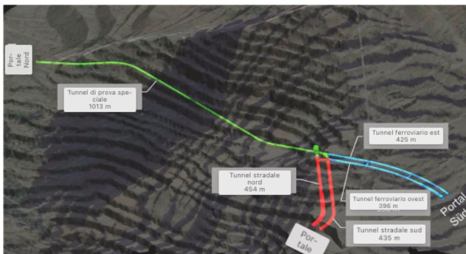
Figura 37: Tunnel di prova dei test
