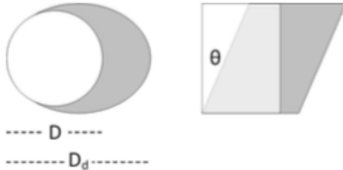
Figura 72: Ellisse di deformazione  $D_d$  e angolo di deformazione rispetto alla normale alla pozza.
