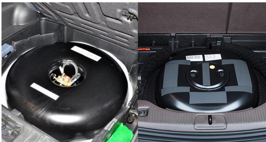
*Figura 6: Due serbatoio di GPL collocati nel vano dedicato alla ruota sostitutiva, Safety Car Rimini*
