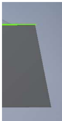
Figura 2.13: Dettaglio della lente di figura 2.12 per evidenziare la rastremazione di 10^\circ
