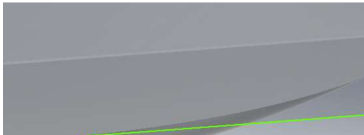
Figura 2.14: Dettaglio della lente di figura 2.12 per evidenziare la smussatura ai bordi
