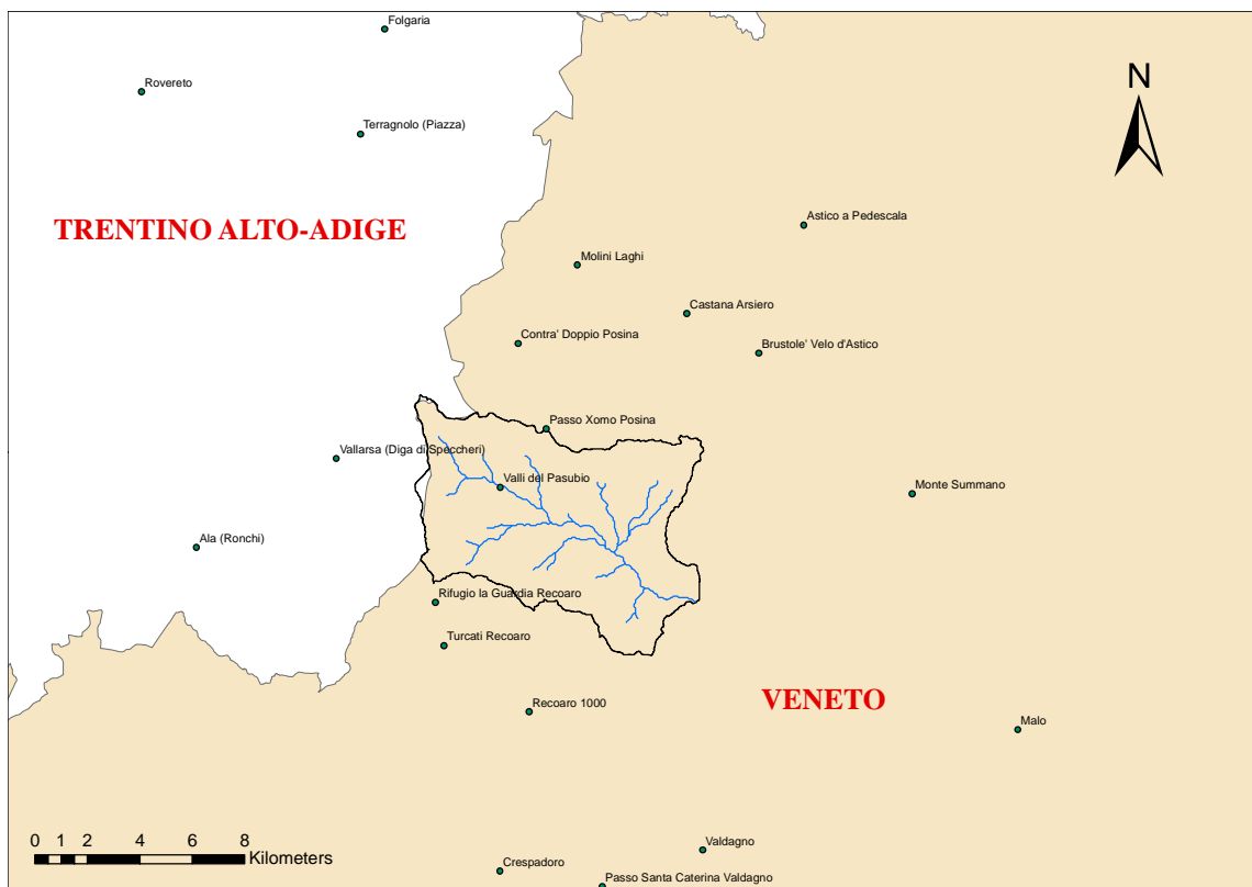
Figura 2.1: Collocazione delle stazioni pluviometriche utilizzate rispetto al bacino di studio.
