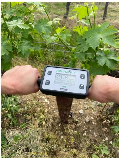
**FIGURA 11 RILEVAMENTO DEL CONTENUTO IDRICO DEL SUOLO**
