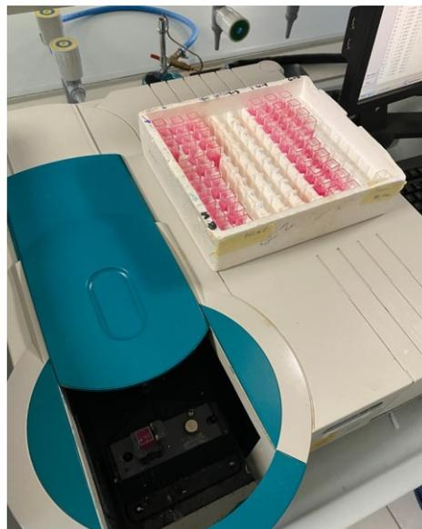
FIGURA 15 SPETTROFOTOMETRO PER LA QUANTIFICAZIONE DEI POLIFENOLI
