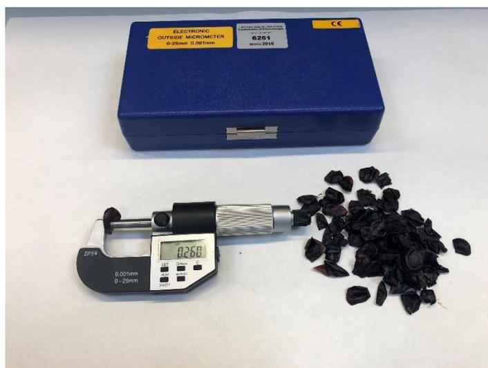
FIGURA 16. CALIBRO UTILIZZATO PER LA MISURA DELLO SPESSORE DELLA BUCCIA
