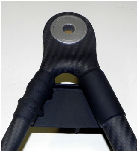
Figura 276 - Verniciatura completa su triangolo anteriore alto.
