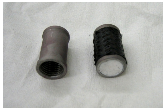
Figura 234 - Boccola filettata preparata con pelle avvolta e pasta siliconica per la protezione del filetto dal lato esterno.
