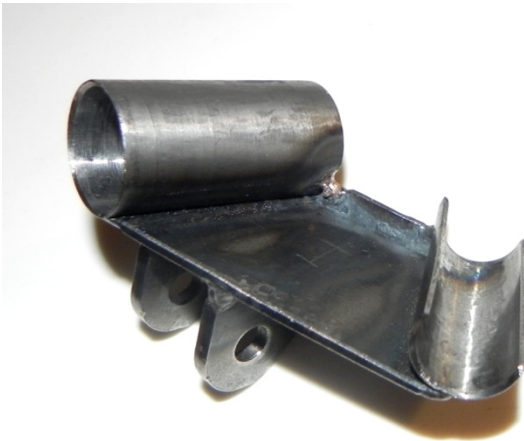
Figura 266 - Attacco del tirante anteriore sinistro.
