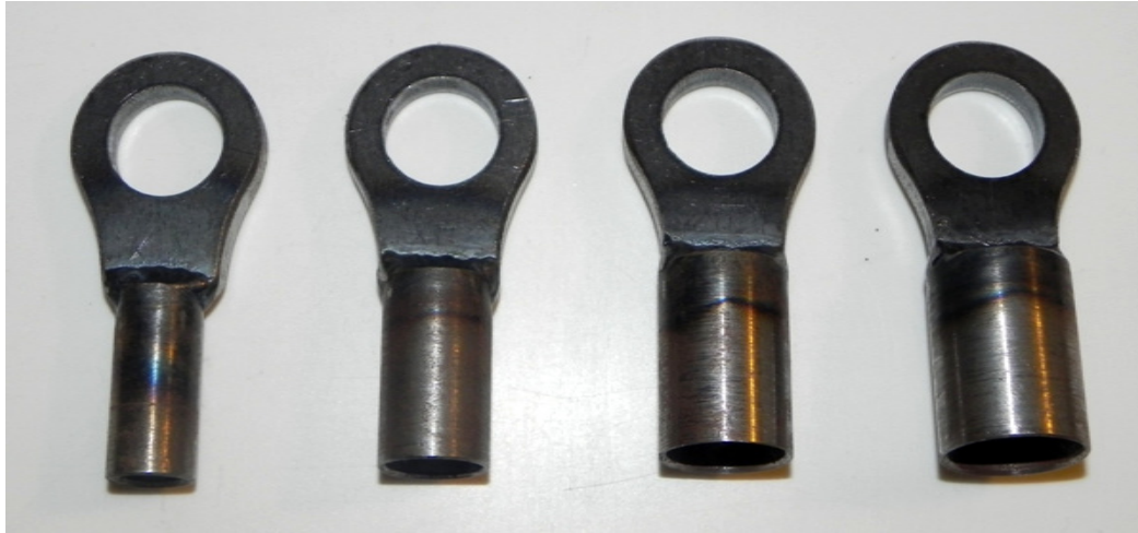
Figura 261 - Elementi realizzati per la connessione a telaio.
