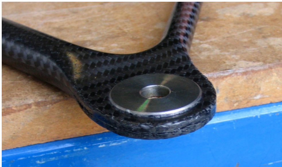
Figura 251 - Effetto della scarsa compressione delle pelli sugli spigoli.
