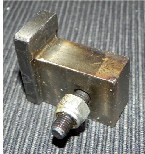
Figura 269 Maschera di saldatura per l'attacco posteriore.
