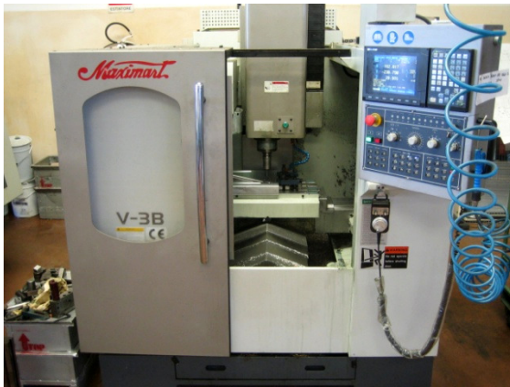
Figura 227 - Fresa a tre assi utilizzata per gli stampi.
