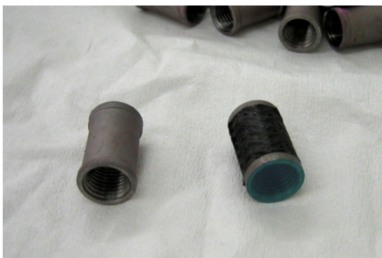
Figura 233 - Boccola filettata preparata con pelle avvolta e nastro adesivo per il lato a contatto con la schiuma.
