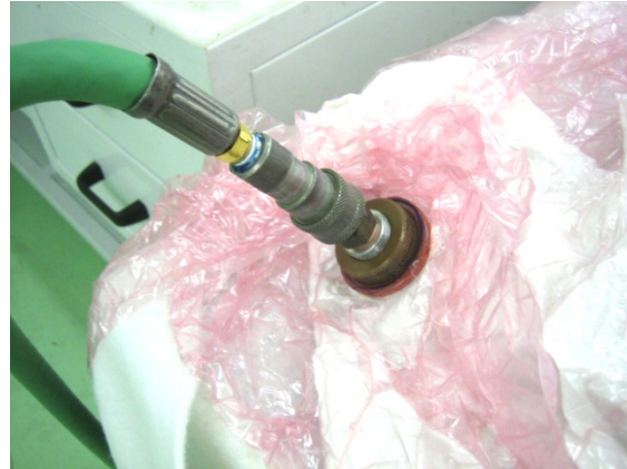
Figura 250 - Valvola per il collegamento della pompa a vuoto.
