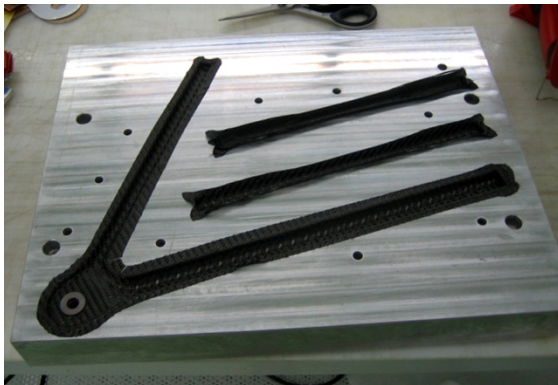
Figura 242 - Laminazione della prima pelle.
