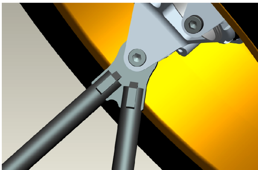
Figura 158 - Immagine CAD a mostrare la connessione iperstatica tra i bracci del triangolo, a creare un V solida.
