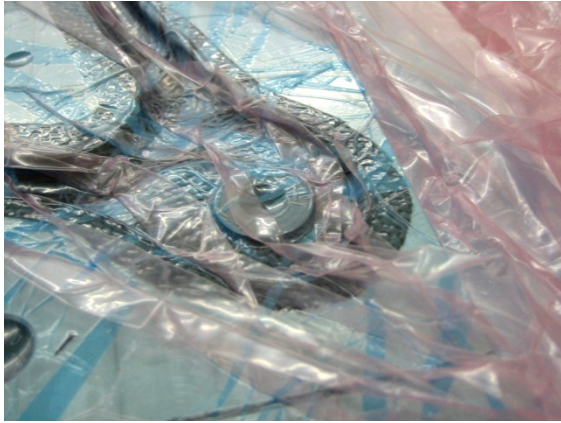
Figura 246 - Vuoto intermedio per comprimere e compattare le pelli nei particolari dello stampo.
