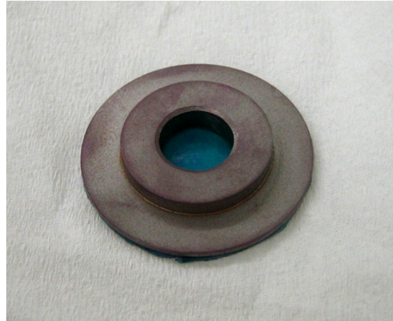
Figura 236 - Sede del giunto sferico con lato interno sabbato e protetto da antiossidante.
