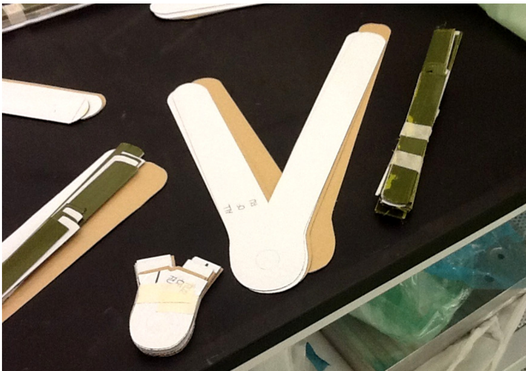
Figura 239 - Pelli tagliate protette dagli strati plastici del rullo.
