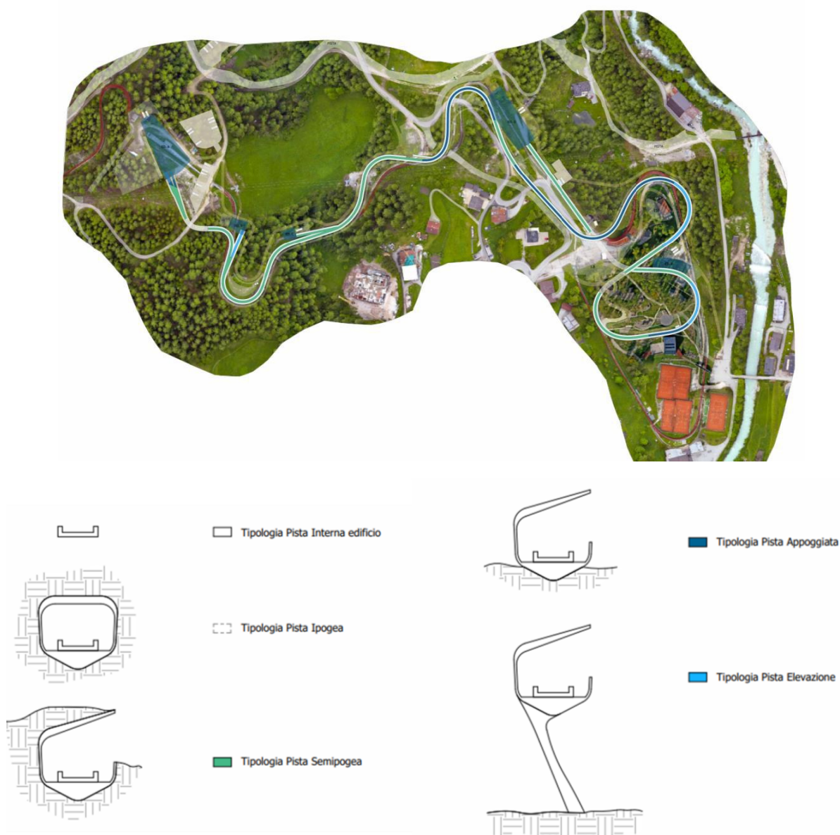
Figura 43: Schema planimetrico e grafico delle sezioni tipologiche.
