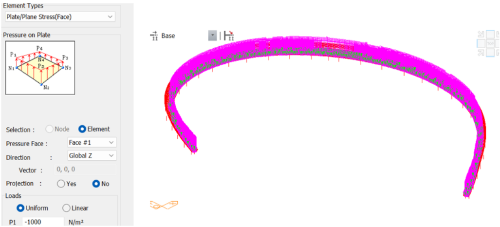
Figura 165: Carico manutenzione Qm.
