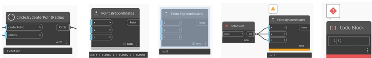
Figura 13: Stato di esecuzione dei nodi.
