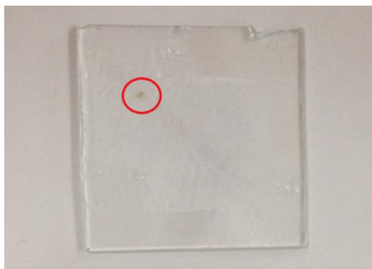
Figura 2.3 Base del chip microfluidico dopo esser stato disaccoppiato dal silicone: nel tondo si mostra il pattern di ITO che è stato a contatto con una soluzione di PBS e a cui sono stati applicati potenziali negativi. L'effetto di intercalazione è visibile anche ad occhio nudo.
