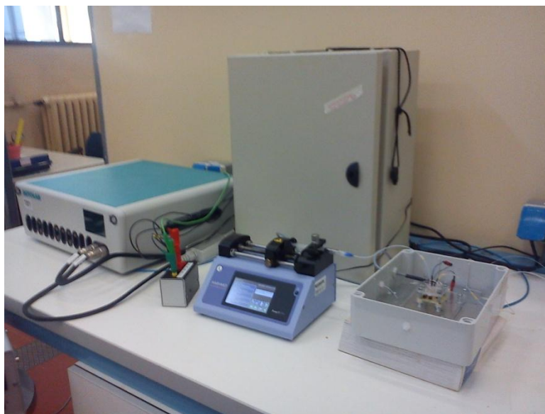
Figura 3.4 (Da destra a sinistra) Sistema di alloggiamento della piattaforma microfluidica, pompa a siringa per l'inserimento dei liquidi, sistema di connessione con lo strumento e apparecchiatura con la quale si realizzano le misurazioni.
