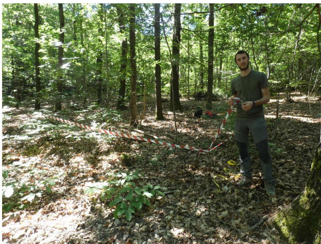
Fig. 2.12.b: Determinazione del plot 10x10 m 2 nel quale viene svolto il cavallettamento forestale semplificato. Per la delimitazione dell'area si sono utilizzati la bussola, il telemetro laser, la cordella metrica e il nastro bianco-rosso.
