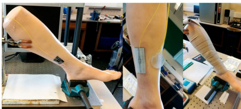
Figura 3 Gamba fantasma su misura mostrata con sensori in fibra ottica in FBG con bendaggio completo.
