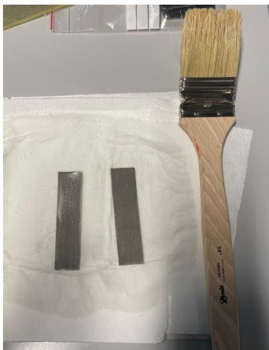
Figura 2.12: Fosfatazione con verniciatura a pennello.
