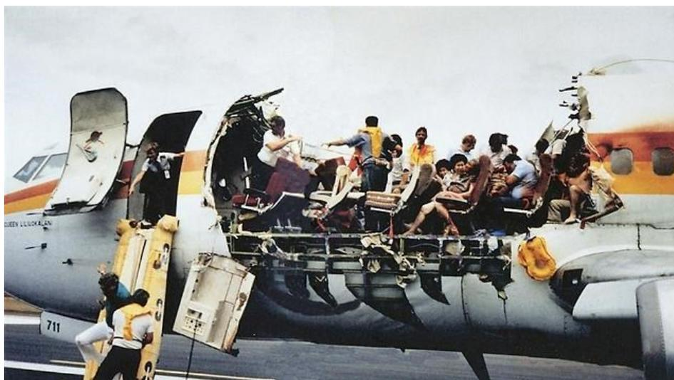
*Figura 1.2: Decompressione esplosiva durante il volo del Boeing 737 Aloha Airlines.*
