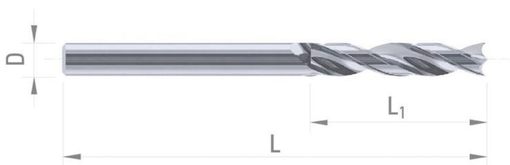
Figura 5.5: geometria di riferimento utensile DIXI™ 1290.
