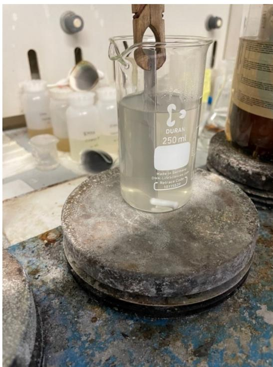
Figura 2.11: Fosfatazione per immersione ad una temperatura 45±2°C.
