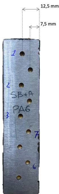
Figura 5.7: Provino tipo II (80x20mm) forato.
