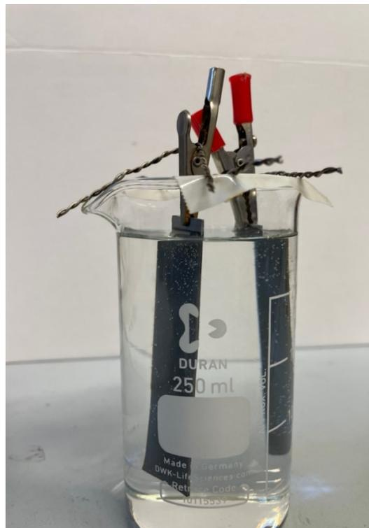
*Figura 2.10: Fosfatazione per immersione a temperatura ambiente.*
