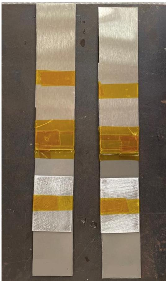
*Figura 3.3: Due provini per il test di taglio assemblati con nastro Kapton.*
