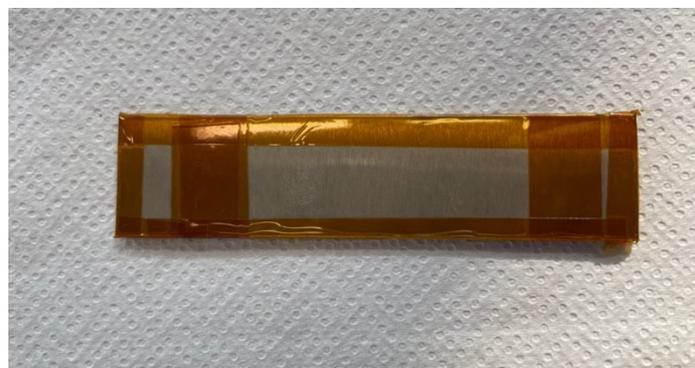
Figura 3.5: Provino assemblato con il nastro Kapton.
