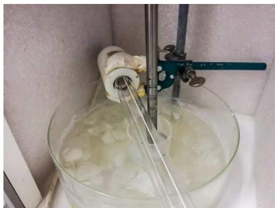
**Figura 6.2** Foto del set-up impiegato nei test con sonicatore a sonda
