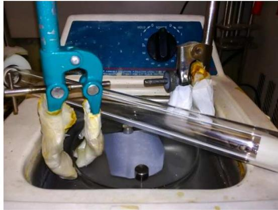
**Figura 6.1** Foto del set-up impiegato nei test con bagno a ultrasuoni
