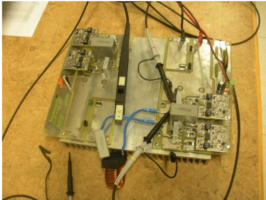
Figura 57: Ponte intero presente in laboratorio
