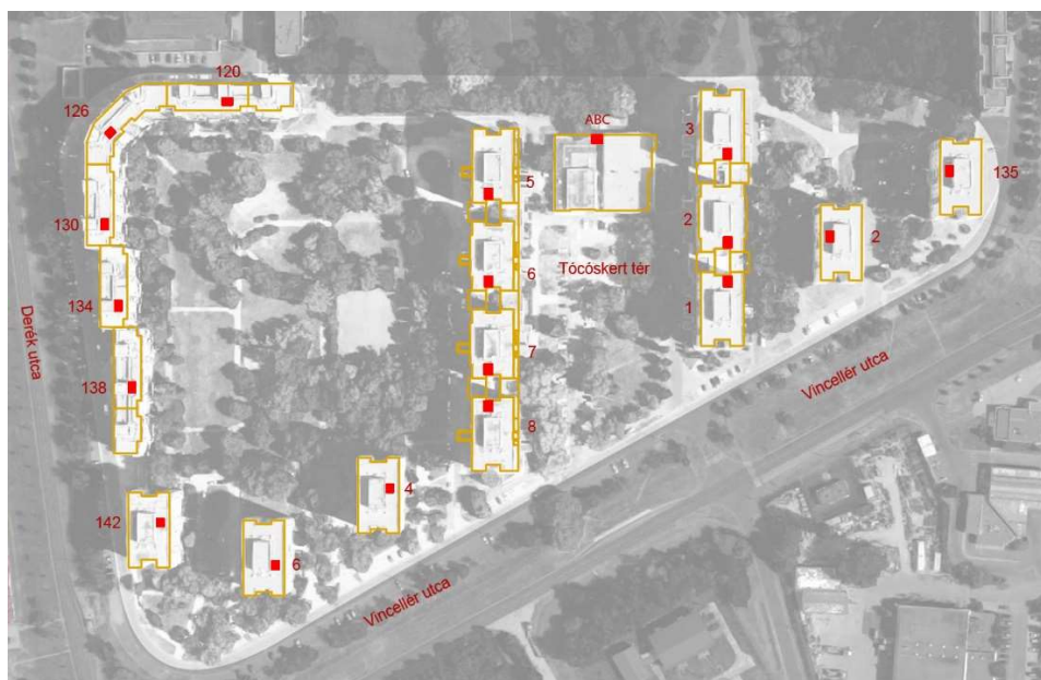
Figura 7.2 – Evidenziazione edifici e sottostazioni secondarie
