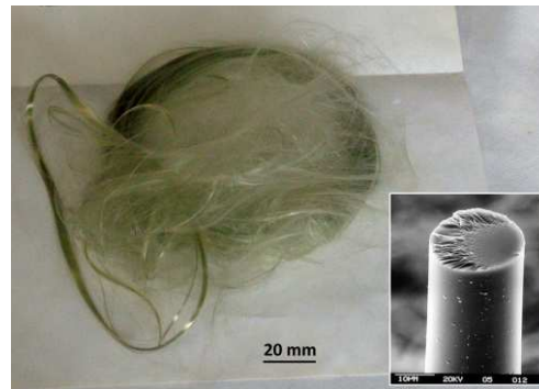
Figura 3.2. Esempio di fibra di vetro da rifiuti vetrificati e particolare :classica immagine sem di una singola fibra.
