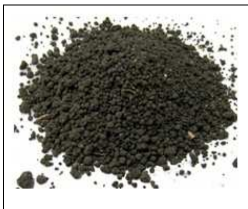
Figura 5.1. Fango essiccato per cinque ore a 120 °C
