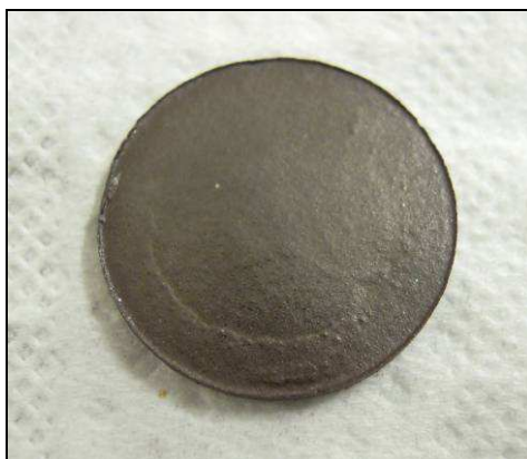
Figura 10.7. B50-37 \mu\text{m} dopo cottura a 950°C
