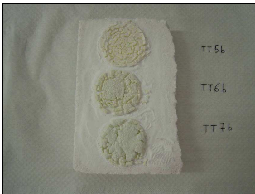
Figura 11.2. Campioni dopo cottura a 1100°C, 30 minuti, 40°C/minuto.
