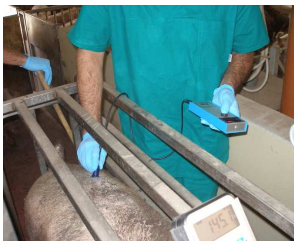
Figura 5. Misurazione dello spessore del lardo dorsale.
