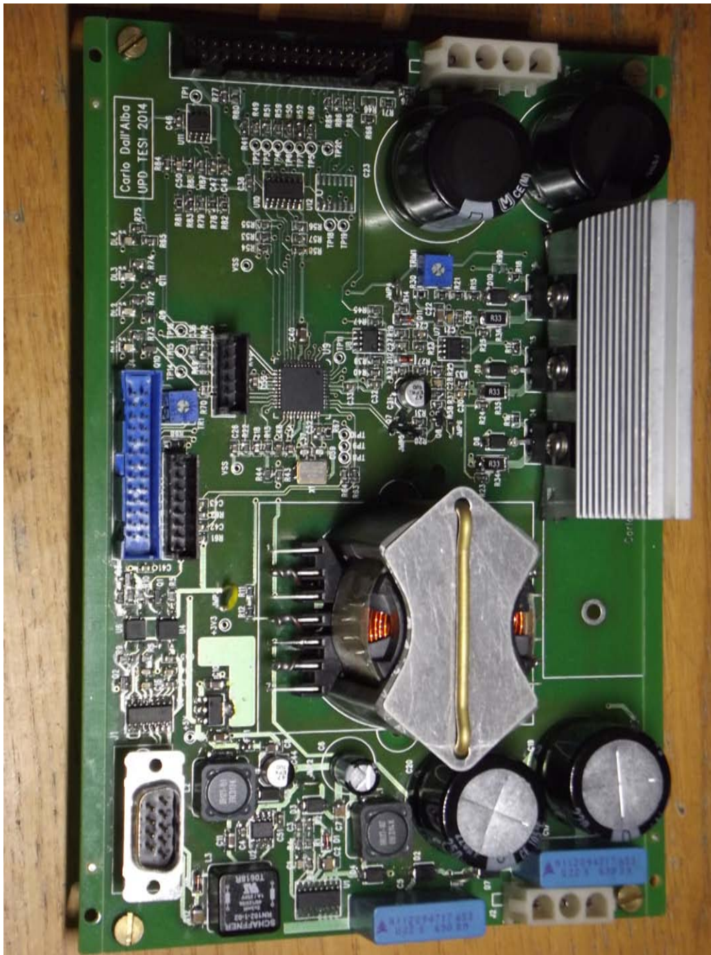
Figura 6.1: Scheda elettronica del boost e controllo montata.
