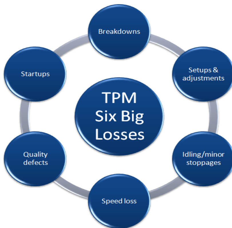
Figura 5.3: Le sei perdite fondamentali secondo il TPM
