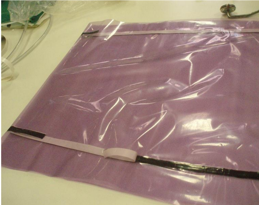
Fig.3.12. Stesura del butilene su un lato del sacco
