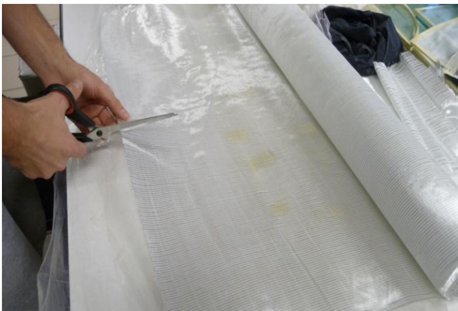
Fig.3.9. UD in fibre di vetro.
