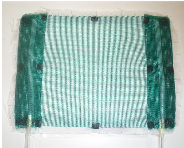
Fig. 3.11. Immagine dello stampo pronto per essere inserito all'interno del sacco.
