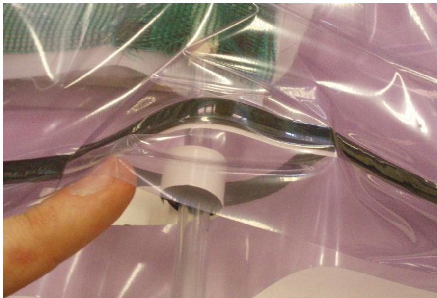
Fig.3.13. Dettaglio sulla chiusura del sacco, lato canali.
