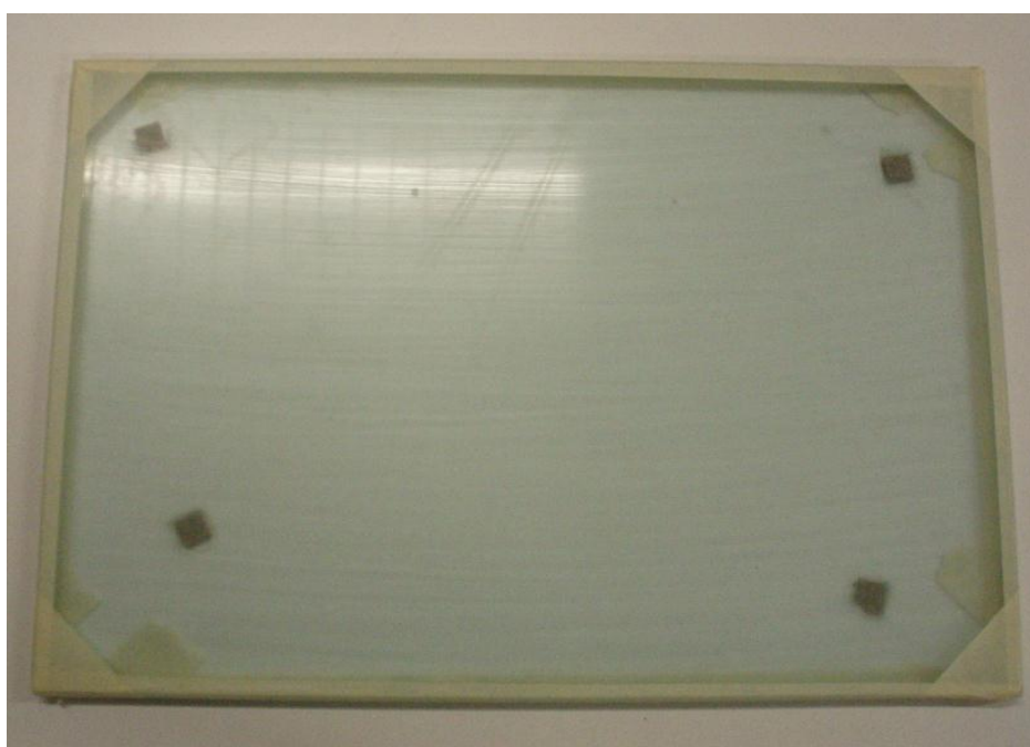
Fig.3.6. Posizionamento del butilene e dello scotch carta.
