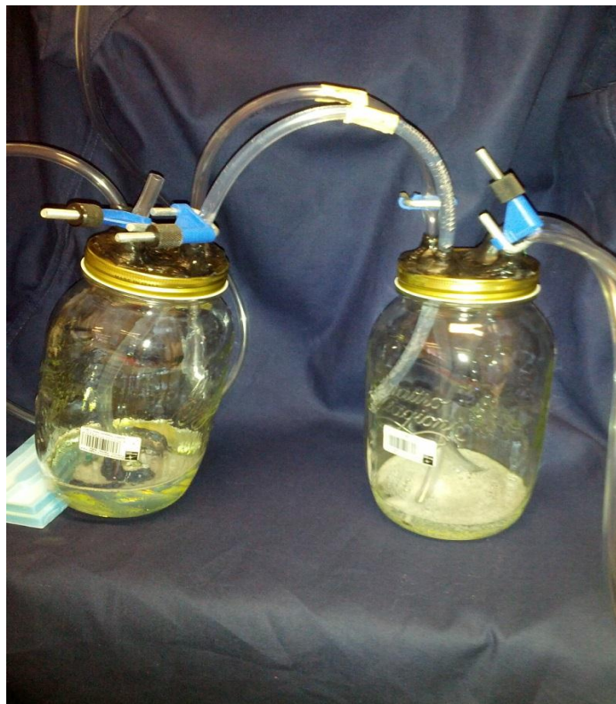
Fig.3.17. Degassaggio della resina.
