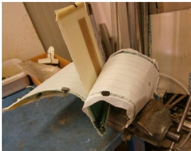
Fig.3.22. Rimozione dei peel-ply ed estrazione del laminato.
