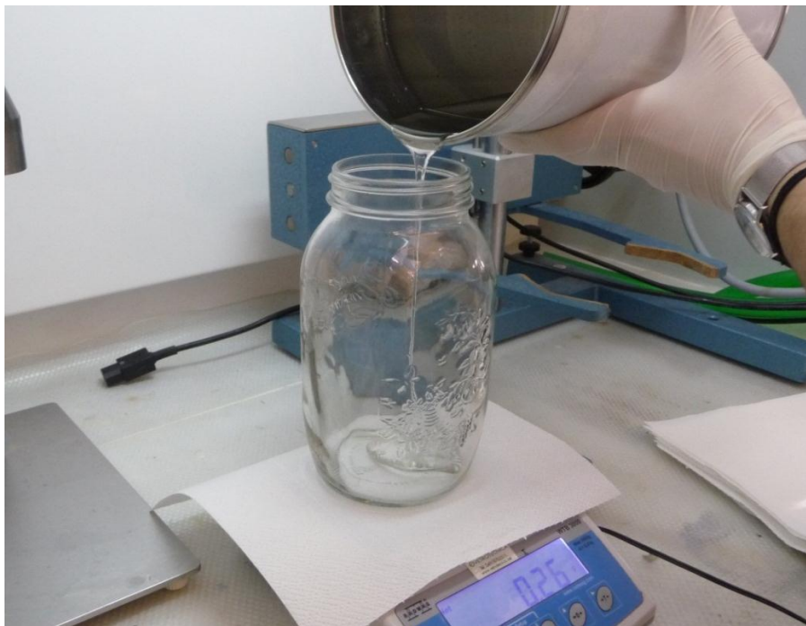
Fig.3.15. Misura del quantitativo di resina usata per l'infusione.
